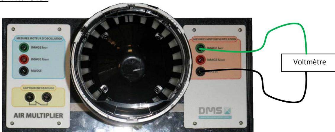
Courant du moteur ventilateur (ampère)=  $\text{imagerI}_{\text{mot}}(\text{volt}) / 43.6$
