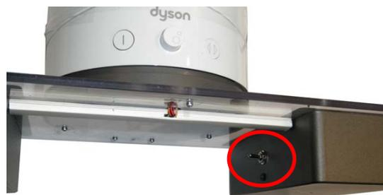
L'alimentation de la partie mesure est réalisée par deux piles 9V situées dans le boîtier comportant l'interrupteur, si le voyant ne s'allume pas il faut remplacer ces piles.
