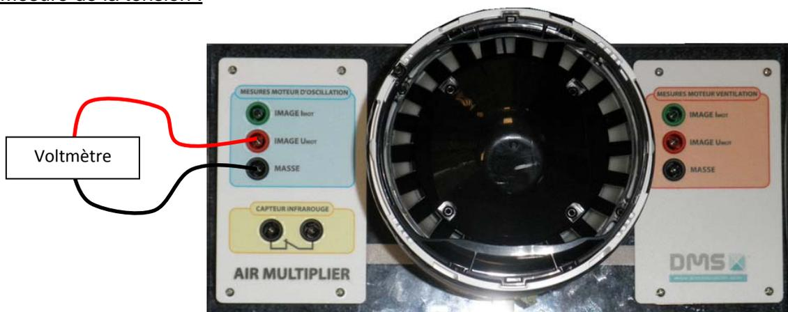
Tension du moteur oscillation (volt) =  $\text{imageUmot}(\text{volt}) * 25$
